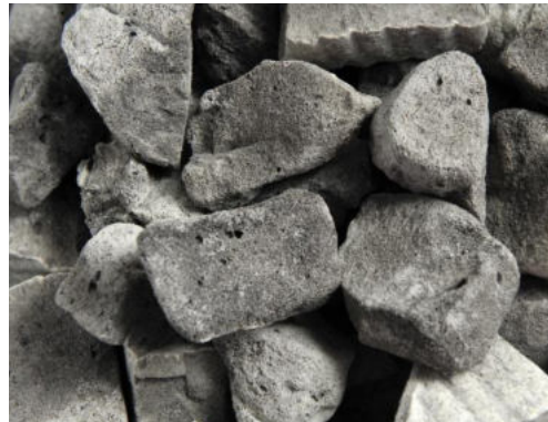
Beim Abkühlen bricht der Kuchen durch Spannungsrisse zu Schaumglas
